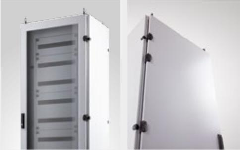
**Armadio con vano cavi:** struttura assemblata, in lamiera, montanti spessore 20/10 mm con vano affiancato dedicato ai cavi, alla morsettiera o al sistema sbarre.
