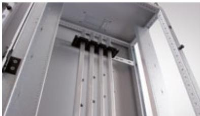
**Telaio interno di cablaggio:** composto da due profili verticali in lamiera Aluzinc® spessore 20/10 mm per il fissaggio del sistema ModularDIN™ e dei rialzi di qualsiasi marca di interruttori.
